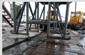
– изготовлена силами ремонтного участка ПБР передняя опорная подставка, с проемом для возможности проезда установки над устьем проектной скважины;
