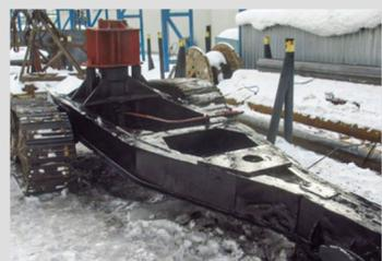
– передняя тележка «Восток», а именно увеличена высота выдвижного цилиндра для возможности подъема буровой установки и перемещения на устье проектной скважины за один раз. До этого в связи с повышенным основанием данной буровой установки приходилось применять две тележки «Восток»: одну повышенную, вторую – со стандартными размерами;
