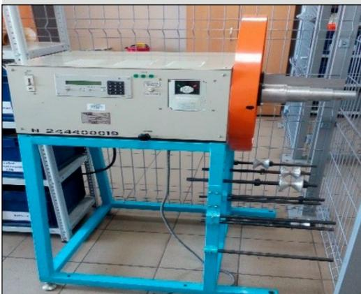
Это оборудование позволяет в автоматическом режиме производить намотку катушек, устанавливая на станок одновременно несколько барабанов с разным типоразмером проводов, с помощью педали управлять всем процессом, регулируя скорость намотки. С тыльной стороны, где установлен шаблон катушек, имеется штатная линейка, позволяющая точно выставлять размеры обмоток.
