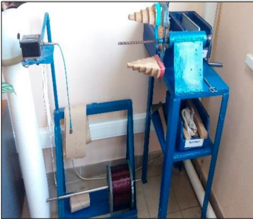
На этом станке приходится вручную крутить барабан с шаблонами, направляя провод руками. Количество витков отсчитывается механическим счетчиком. Наматка катушек таким способом требует значительных временных затрат. В связи с этим увеличивается и время, затрачиваемое на ремонт одного электродвигателя.
