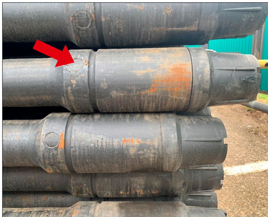
Место установки RFID-метки в высверленном (фрезерованном) пазе на теле замка
