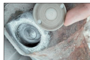
RFID метка в теле замка бурильной трубы
